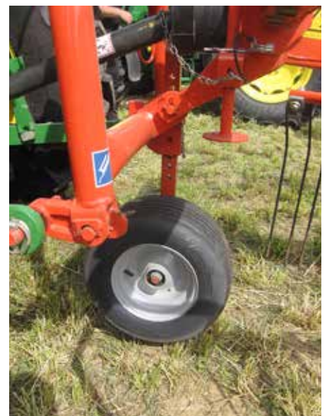
Če želimo čim boljše kopiranje terena, mora imeti zgrabljalnik z eno vrtavko tudi podporno (tipalno) kolo.
