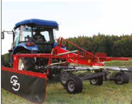
Upognjeni vzmetni prsti pri SIP-ovem zgrabljalniku STAR.
