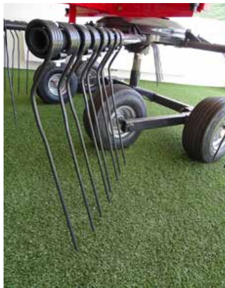
Upognjeni vzmetni prsti pri SIP-ovem zgrabljalniku STAR.
