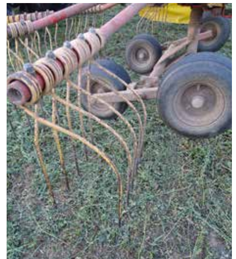
Dvojni (»twin«) vzmetni prsti na zgrabljalniku Niemeyer (ali Ziegler) so bili posebnost. Na nosilcu sta bila pritrjena dva niza vzmetnih prstov.
