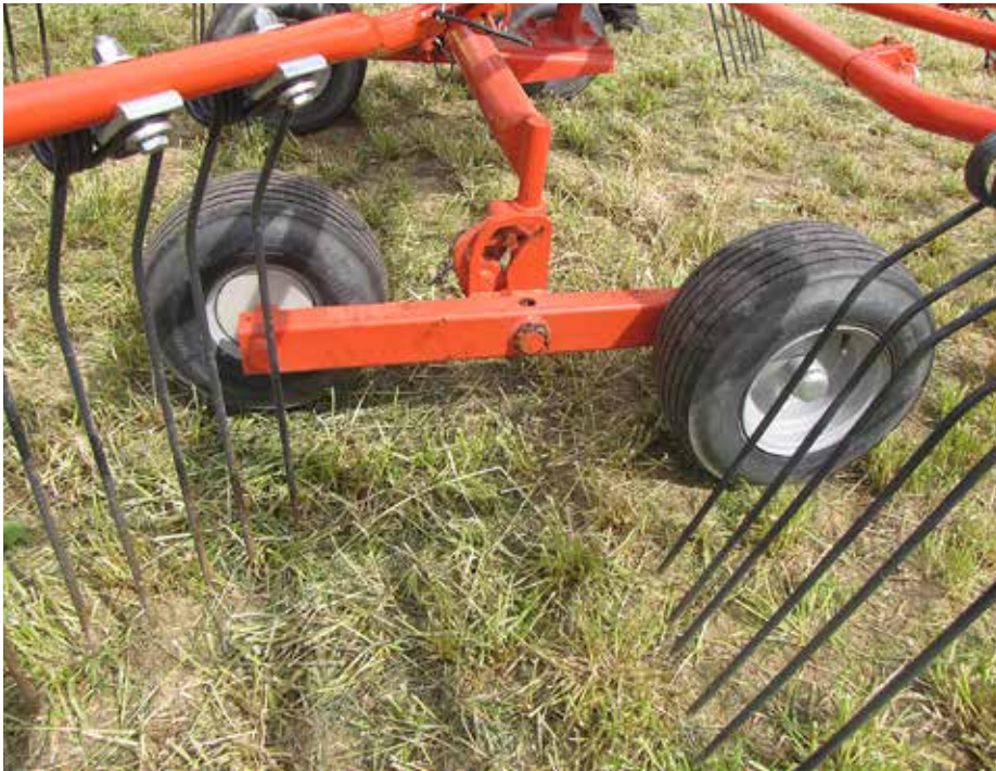
Tandemsko podvozje omogoča najboljše prilagajanje zgrabljalnika k tlom.
