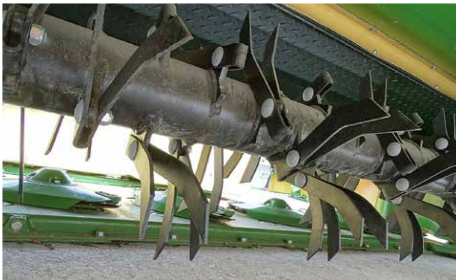
Jekleni V prsti na prstnem gnetilniku diskaste kosilnice Krone EasyCut F 320 CV. Jekleni prsti delujejo na pokošeno krmo agresivneje in so namenjeni za težje razmere delovanja.
