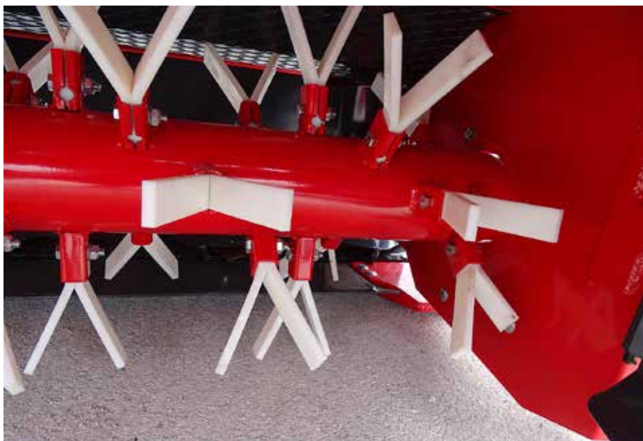
Prstni gnetilnik s plastičnimi delovnimi elementi (prsti) v obliki na SIP-ovi diskasti kosilnici. Togo so vpeti, z uporabo se počasi zaobljijo. Tak gnetilnik je lažji od prstnih gnetilnikov z jeklenimi delovnimi elementi.
