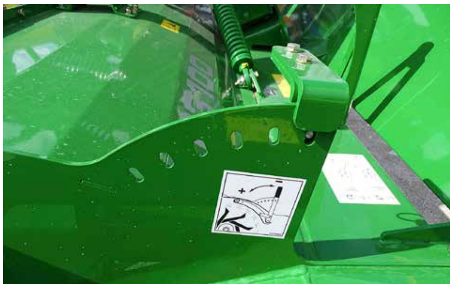
Sistem za nastavitve intenzivnosti gnetenja na kosilnici Mc Halle RC 3100 Proglide.
