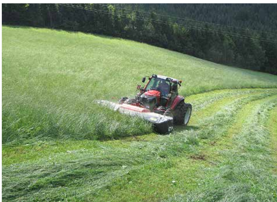
Lindner Lintrac 90 s čelno nameščeno SIP-ovo diskasto kosilnico DISC 300 F ALP. Ta traktor ima možnost vklopa upravljanja vseh štirih koles. Zadnja se lahko obrnejo do 20 stopinj. Stabilnost traktorja na nagibu bistveno povečajo dvojna kolesa spredaj in zadaj.
