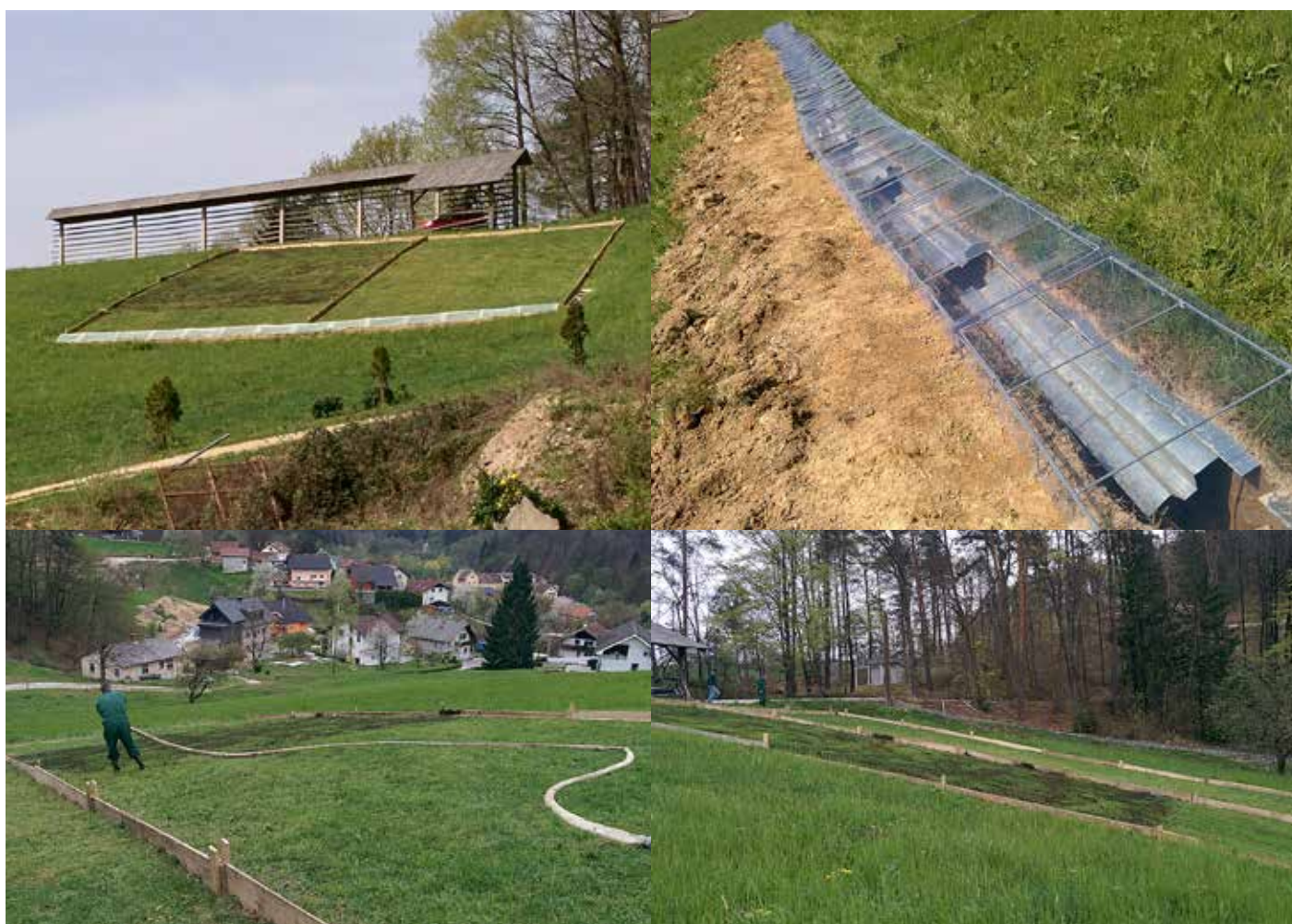
Slika 1: Postavitev poskusne ploskve (levo zgoraj), namestitve žlebov za zbiranje površinskega odtoka v jarku (desno zgoraj), gnojenje poskusne ploskve z gasilskimi cevmi (levo spodaj) in nagib poskusne ploskve (desno spodaj).
