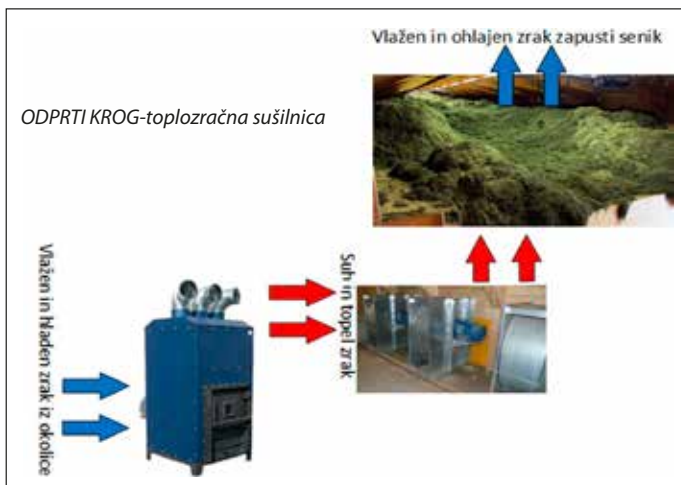
Slika 4: Odprti krog sušenja značilen za vse hladnozračne in toplozračne sušilnice.
