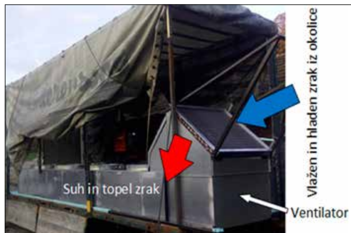
Slika 1: Sistem sušenja z uporabo toplotnega izmenjevalca – dogrevanje z biomaso ali s toploto iz bioplinarne (mobilna sušilnica).
