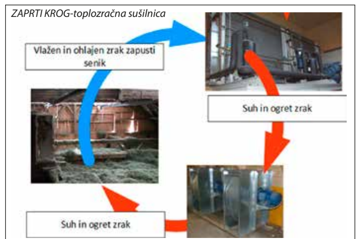
Slika 5: Zaprti krog sušenja - kondenzacijska sušilnica.
