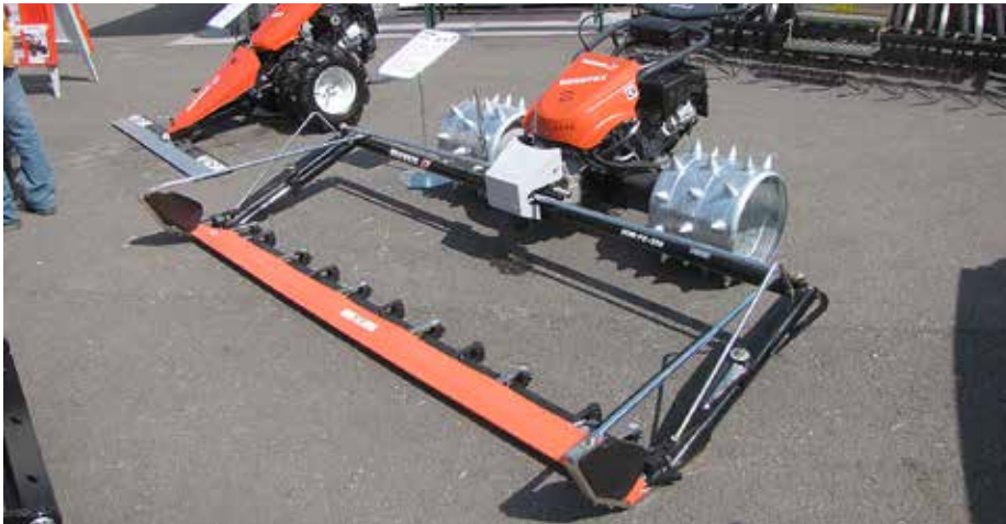
Reform Bergfex je predstavnik hidrostatične ročno vodene motorne kosilnice, ki ima več kot 2 metra široko strižno kosilnico. Za večjo stabilnost na nagibu je opremljen z nazobčanimi kovinskimi kolesi.
