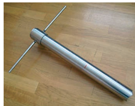
Slika 1: Sonda za odvezanje vzorcev silaže in sena (dolžina 0,5 m; premer cevi 50 mm). S sondo lahko določimo tudi potlačeno silažo v silosu ali v bali.
