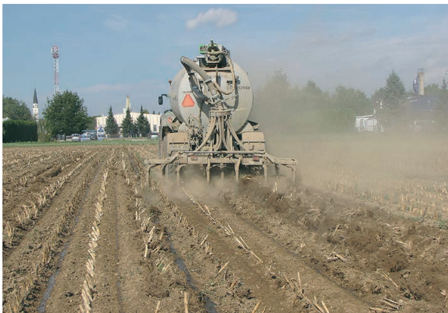
Cisterne za gnojevko s sistemom za vnašanje gnojevke v tla (injiciranje ali vbrizgavanje gnojevke v tla), ki omogočajo istočasno plitko obdelavo in razdeljevanje gnojevke so opcija in konzervirajočo obdelavo tal brez oranja. Tovrstni sistem je primeren za predsetveno gnojenje in obdelavo za pridelavo krme na njivah, pa tudi za druge poljščine. Sledi še prehod s kultivatorjem in tla so pripravljena za setev. Taka zadelava gnojevke zmanjša izpuste, potreben delovni čas in število prehodov s težko mehanizacijo.
