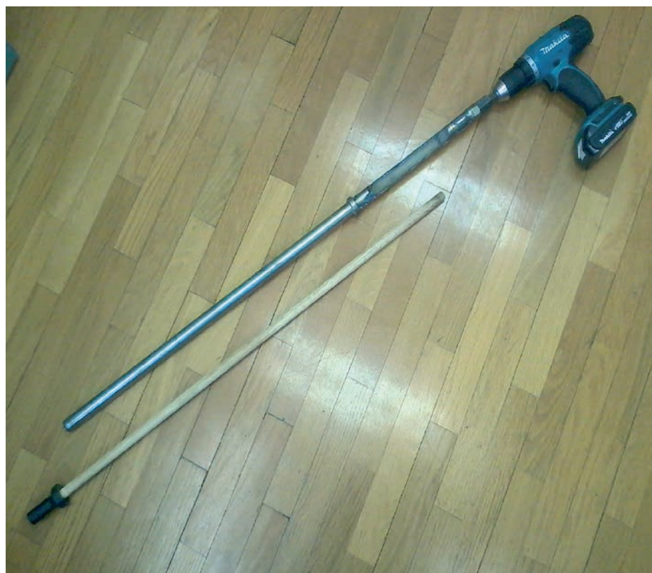
Slika 3: Sonda za baterijski vrtnik (dolžina 0,6 m, premer cevi 18 mm) za odvzem vzorcev mrve.
