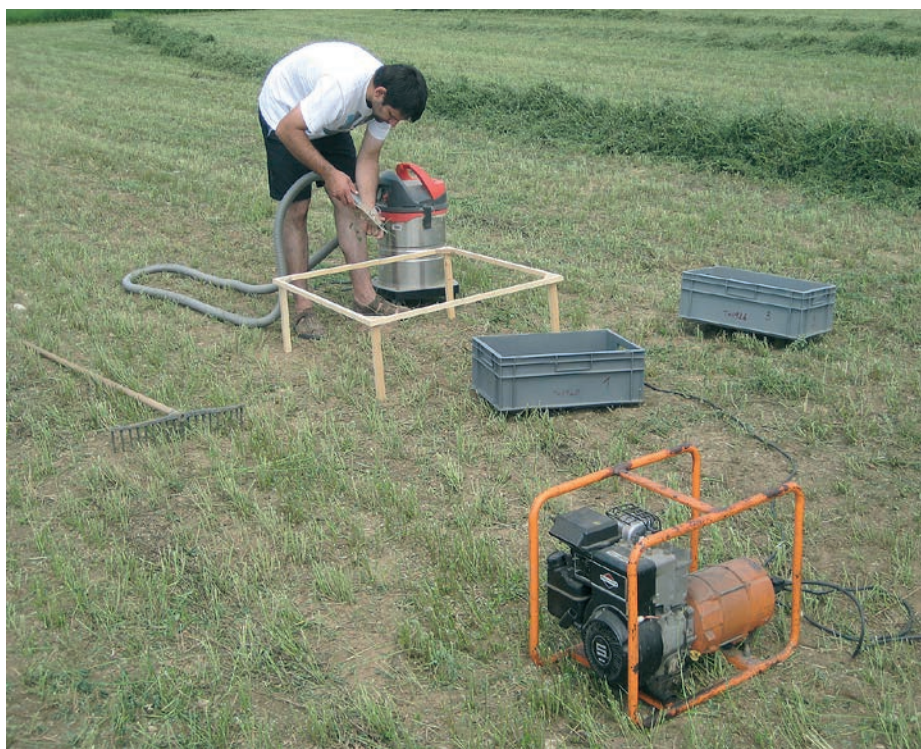
Zbiranje rastlinskih ostankov zaradi drobljenja s pomočjo sesalca na površini 0,9 m 2 , ki smo jo označili z lesenim okvirjem.
