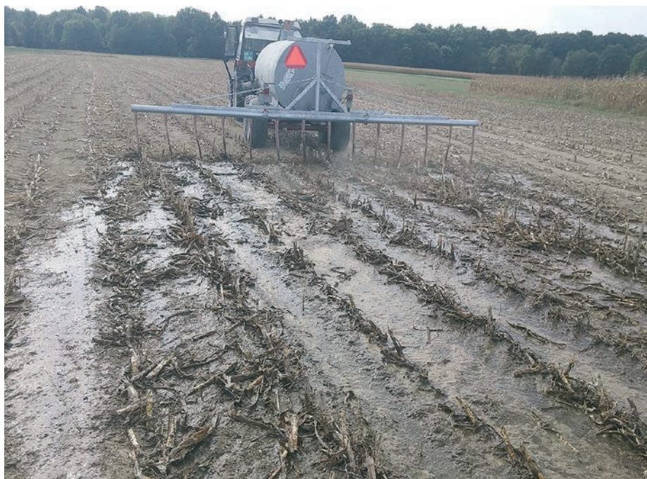
Nekateri kmetje so si sami izdelali razdelilnike z vlečenimi cevmi. Pri takih »inovativnih« razdelilnikih je lahko vprašljiva kakovost enakomerne porazdelitve gnojevke. Profesionalni proizvajalci razdelil za manjše izpuste amonijaka imajo tudi certifikate o kakovosti prečne in vzdolžne enakomernosti porazdelitve gnojevke.
