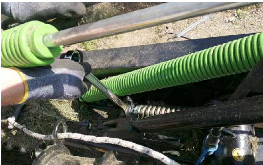
Nekatere konstrukcijske rešitve niso najbolj posrečene: neroden dostop do vijakov za napenjanje pogonskih jermenov.
