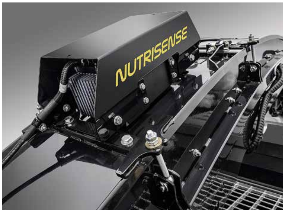
New Hollandov sistem NutriSense z NIR analizatorjem. Vir slike: New Holland
