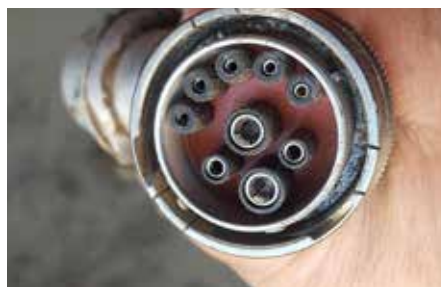
ISOBUS vtičnica na traktorju (zgoraj) in ISOBUS vtikač na stiskalnici (spodaj) podpira ISOBUS prenos informacij.
