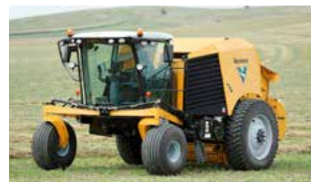
Samohodna stiskalnica za valjaste bale Vermeer ZR5-1200 ima vgrajen dvestokonski motor (vir slike: Vermeer).
