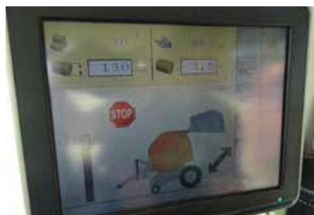
Upravljanje Kuhn stiskalnice VB 3160 preko traktorskega ISOBUS terminala na traktorju John Deere 6100 RC.
