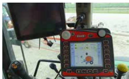
Upravljanje Kuhn stiskalnice VB 3160 preko lastnega Kuhn ISOBUS terminala CCI 50. Zraven je še traktorski ISOBUS terminal, preko katerega bi ravno tako lahko upravljali s stiskalnico.
