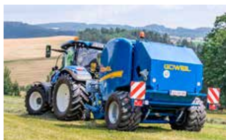
Göweil ima v ponudbi stiskalnico za valjaste bale G-1 F, ki ima aktivno pogonsko os. Aktivna os lahko na nagibu odvisno od smeri vožnje poganja stiskalnico ali pa jo zavira (vir slike: Göweil).
