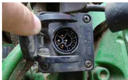
ISOBUS vtičnica na traktorju (zgoraj) in ISOBUS vtikač na stiskalnici (spodaj) podpira ISOBUS prenos informacij.
