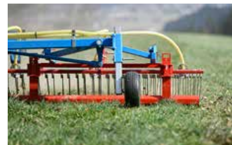
Višino (globino) dela uravnavamo z nastavljanjem nivojskih koles in ravnalne deske.
