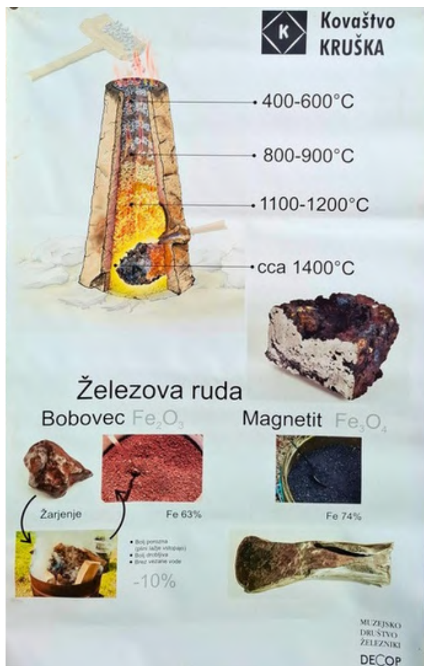
Fotografija razstavnega panoja s prikazom prazgodovinskega tipa talilne peči (po shemi Muzejskega društva Železniki).
