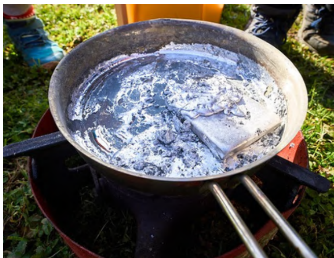
Levo taljenje cinka (tališče cinka je pri temperaturi nekaj nad 400 °C), desno vtisk modela v livarsko mivko.
