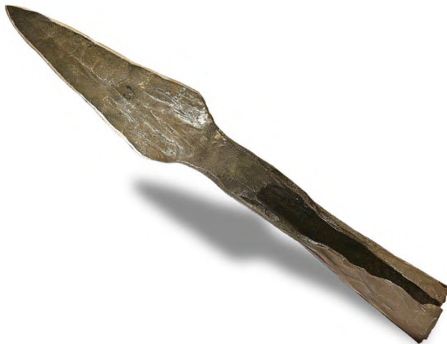
Izjemen izdelek za šolsko zbirko: železna sulična ost z nastavkom za nasaditev, skovana v kovaški delavnici po načrtu Timoteja Kruške in udarci učečih se kovačev OŠ Stična.
