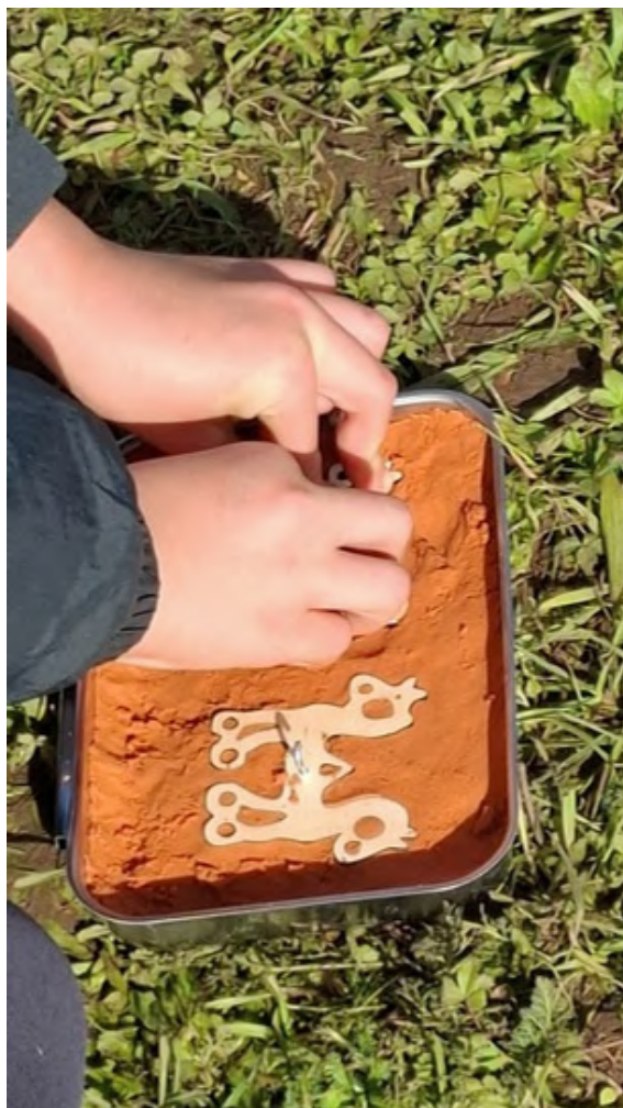
Levo taljenje cinka (tališče cinka je pri temperaturi nekaj nad 400 °C), desno vtisk modela v livarsko mivko.
