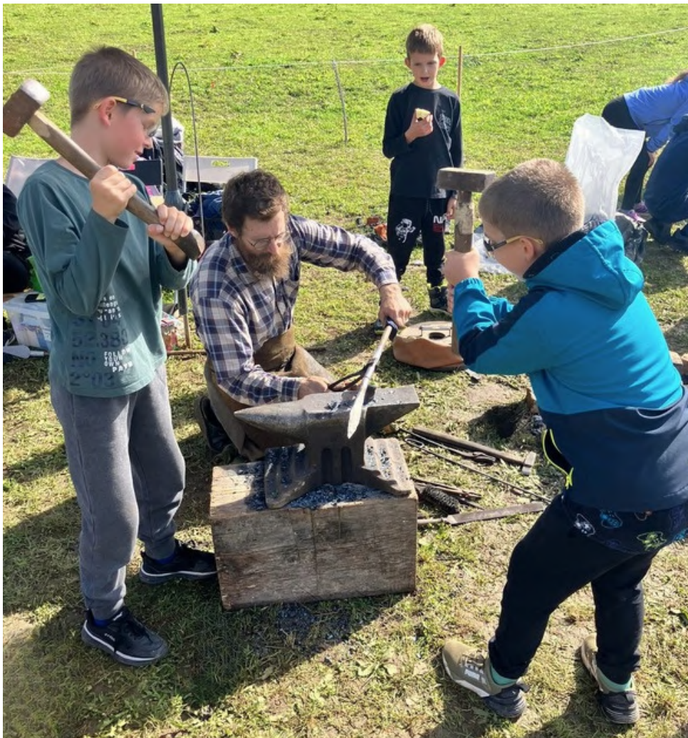
Zametek sulične osti med kladivom in nakovalom ...
