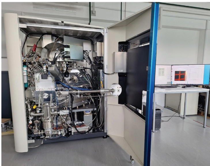
Slika 1: Novi XPS-spektrometer Genesis proizvajalca ULVAC-PHI, instaliran na Institutu »Jožef Stefan«
