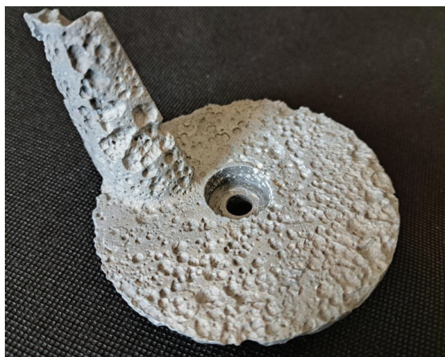
Slika 4: Cinkova žrtvena anoda za izvenkrmni motor čolna po 90 dneh uporabe v morski vodi
