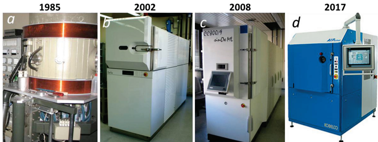
Slika 7: Naprave, ki jih v Centru za trde prevleke v Domžalah uporabljamo za nanos trdih zaščitnih PVD-prevlek na orodja in strojne dele. Njihovo delovanje temelji na: a) naprejevanju z nizkonapetostnim in visokotokovnim elektronskim curkom (BAI 730, Balzers); b) DC magnetronskem naprejevanju (CC800/7, CemeCon); c) DC, pulznem in HIPIMS magnetronskem naprejevanju (CC800/9, CemeCon) in d) naprejevanju s katodnim kom (AlPocket, Kobelco-KCS Europe). Letnice nad slikami naprav pomenijo leto, v katerem smo jih instalirali.
