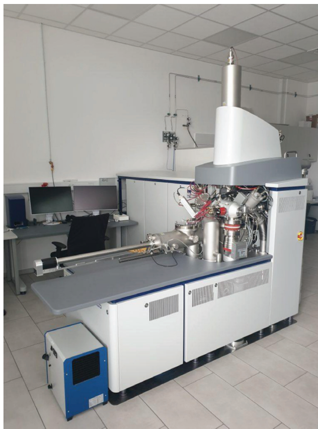
Slika 3: Instrument MS/MS ToF-SIMS, ki je nameščen na Fakulteti za kemijo in kemijsko tehnologijo Univerze v Mariboru.
