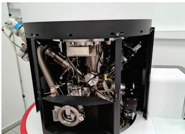
Slika 2: Instrument XPS, ki je nameščen na Fakulteti za kemijo in kemijsko tehnologijo Univerze v Mariboru.
