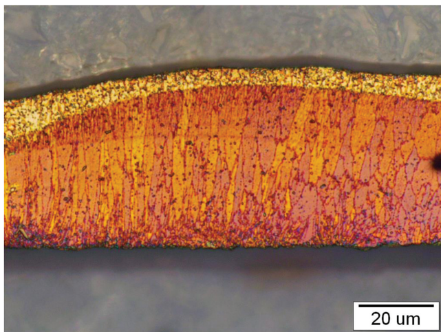
Slika 11: Svetlobni posnetek kvazikristalne zlitine \text{Al}_{89}\text{Mn}_2\text{Be}_2\text{B}_7 , lite na vrteče bakreno kolo
