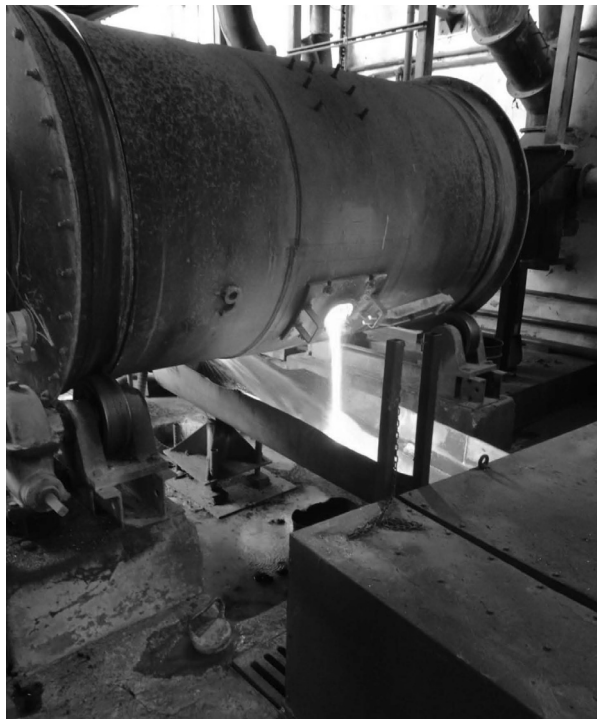
Slika 3: Spust taline iz peči
