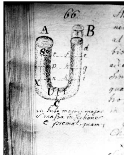
Slika 21: Huberjeva skica ravnovesja v kapljevini kot uvod k opisu vakuumskih črpalk (Huber, Philosophia Corporum , str. 66)
