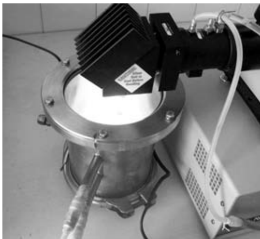
Slika 3: Reaktorski sistem za določevanje učinkovitosti fotokatalitskih materialov pri dnevni svetlobi z uporabo ksenonske svetilke; spektralno obsevanost te svetilke smo merili na razdalji 6 cm.
