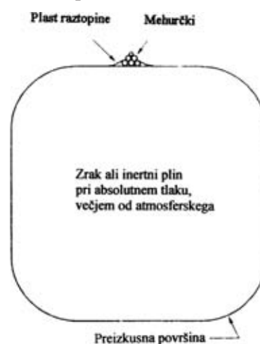
Slika 7: Preizkušavec pod nadtlakom slednega plina pri načinu preizkušanja z omočenjem površine (1)
