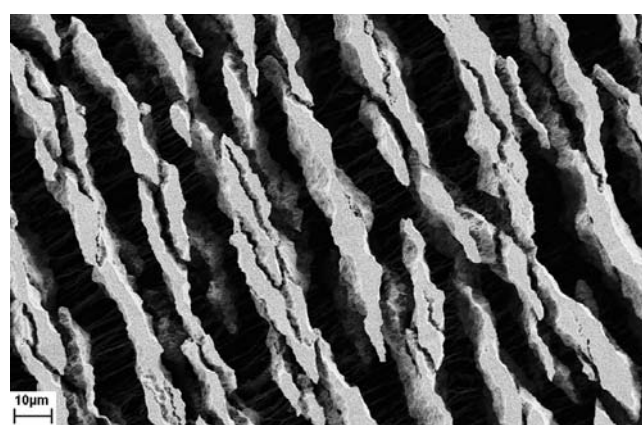
Slika 4: Obdelan vzorec 10 min v kisikovi plazmi
