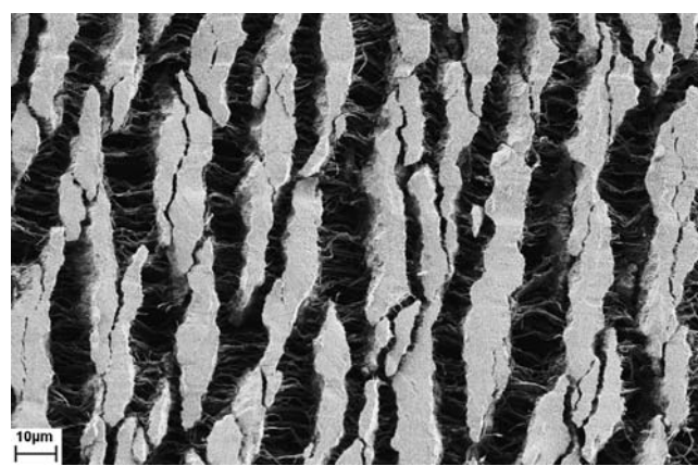
Slika 3: Obdelan vzorec 3 min v kisikovi plazmi
