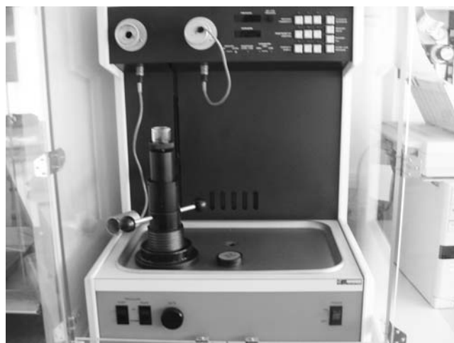
Slika 2: Fotografija živosrebrne porozimetrovske naprave
