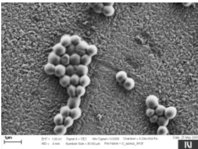
Slika 4: Bakterije Staphylococcus aureus na dobro aktivirani aluminijevi foliji pri veliki povečavi
