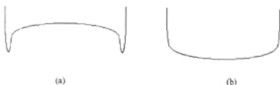
Slika 4: Popačenje kraterja: (a) konkavna oblika, (b) konveksna oblika
