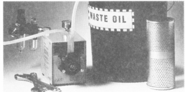
Slika 4: Pretakanje odpadnega olja v zbirno posodo. Pogon črpalke je izveden s stisnjenim zrakom.
