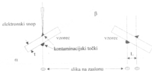
Slika 4. Merjenje debeline vzorca s kontaminacijskimi točkami
