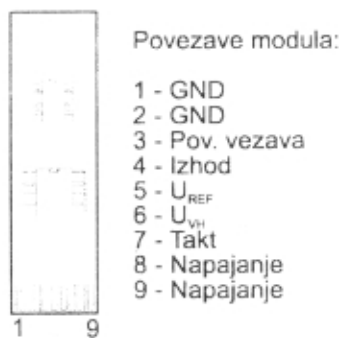
Slika 13. Senzorski vmesnik z A/D pretvorbo ETZ 1012
