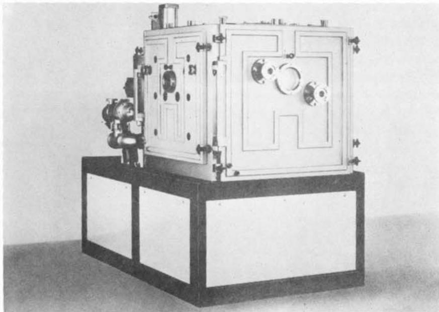
Vollautomatische, industrielle Hartstoffbeschichtungsanlage (PVT 1000) für verschleißbeanspruchte Werkzeuge und Bauteile
