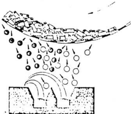
Slika 1 Napajanje s pomočjo preskakujočega elektronskega snopa
