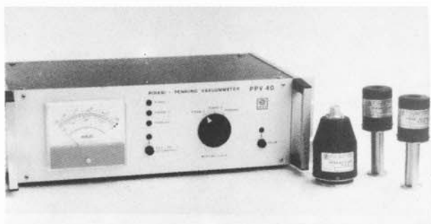
Sl.1. Vakuummeter Pirani-Penning tip PPV 40 s Pirani merilnima glavama tip PRG 2 in Penning merilno glavo tip PNG 2
