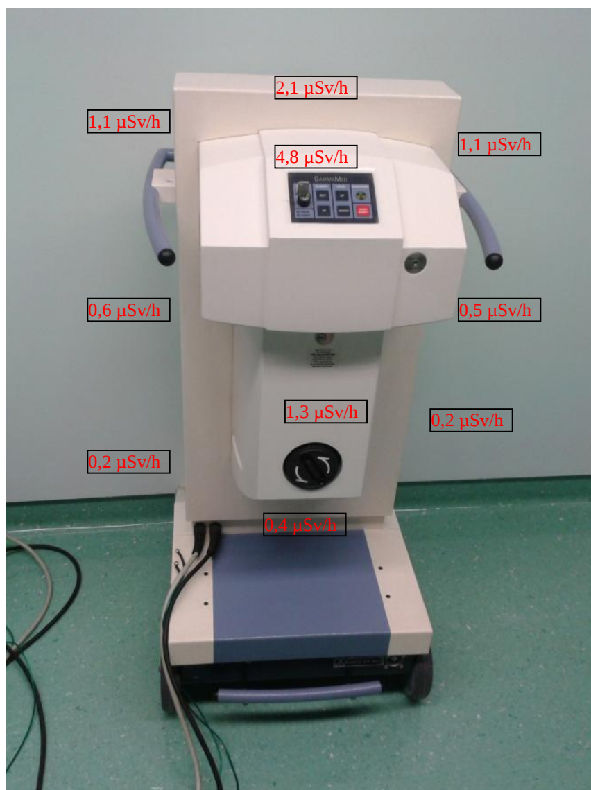
Slika 2: Meritve hitrosti doz na površini naprave GAMMAMED, sprednja stran.
