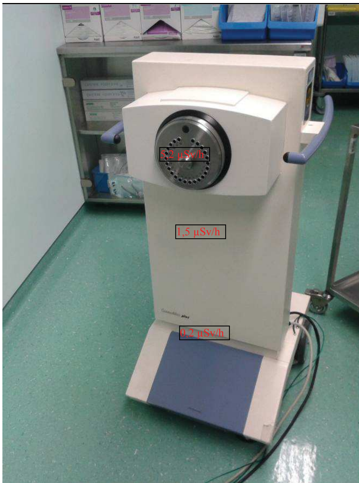
Slika 3: Meritve hitrosti doz na površini naprave GAMMAMED, zadnja stran.
