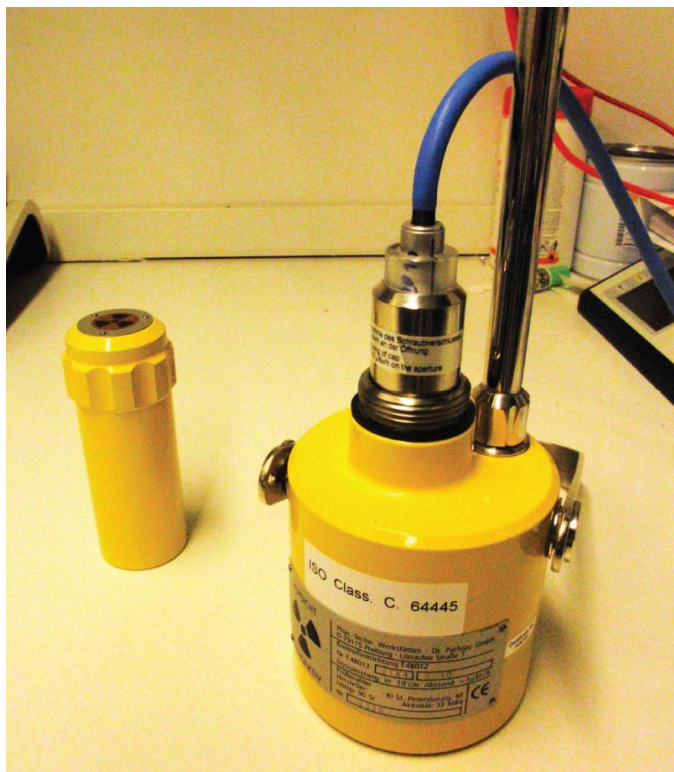
Slika 1: Preverjanje odziva ionizacijskih celic
