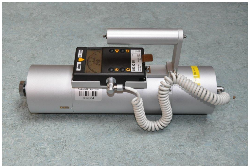
Slika 2: Interna kalibracija merilnika Automess AD 6/H z dodatno sondo s plastičnim scintilatorjem AD-b/H in zaprtim virom Cs-137.
