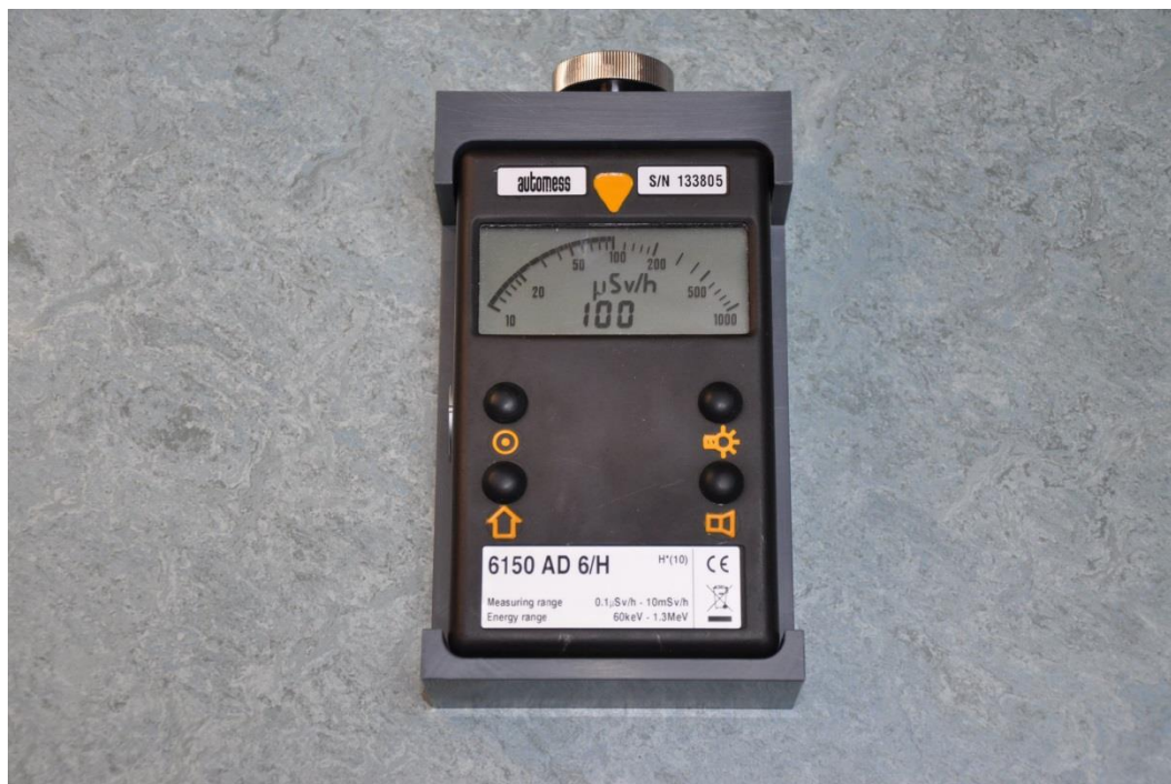
Slika 1: Interna kalibracija merilnika Automess AD 6/H z zaprtim virom Cs-137.
