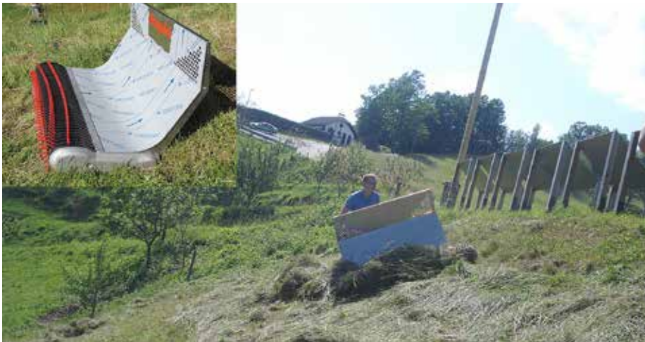
Priključek za grabljenje sena, ki se pripne na enosni traktor (ročno vodene motorne kosilnice, ko jim snamemo kosilnico). Ta priključek (v našem primeru Rapid TWISTER) omogoča grabljenje ali transport sena tudi tam, kjer so zaradi nagiba to prej ljudje delali ročno.
