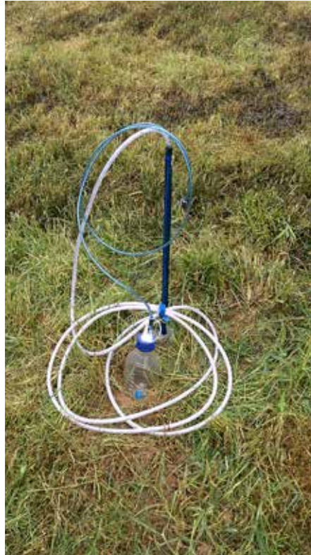
Slika 2: Tenziometrijski lizimeter (levo), sesalna sveča (desno) za merjenje odtoka oziroma vode, ki odteka skozi talni profil.
