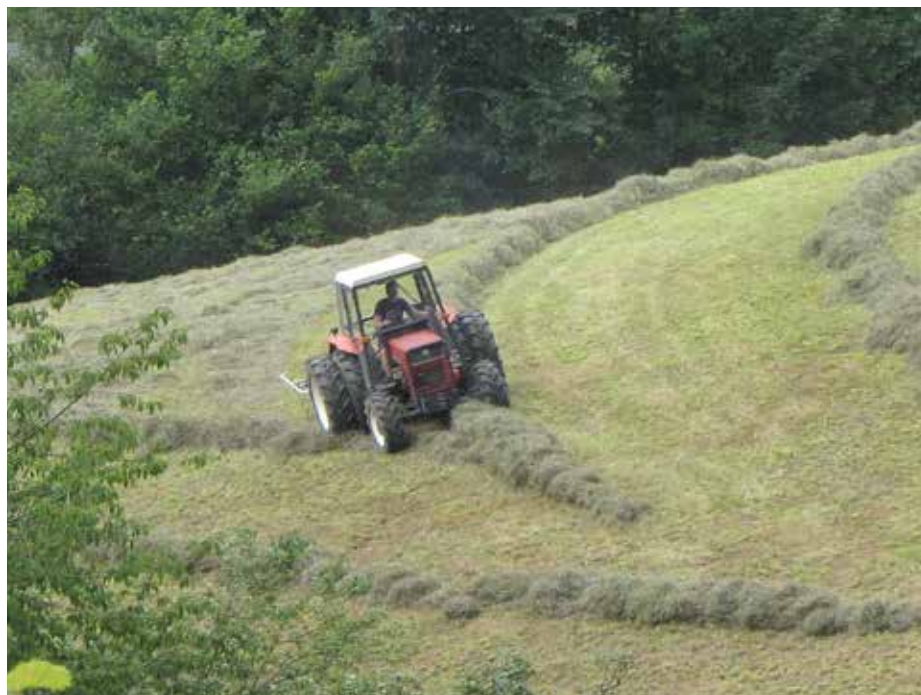
Večjo stabilnost standardnih traktorjev pri delu na nagibu dosežemo z uporabo dvojnih pnevmatik. Zaradi konstrukcijskih lastnosti standardnega traktorja (visoko težišče) pa pride do omejitev pri delu na nagibu.
