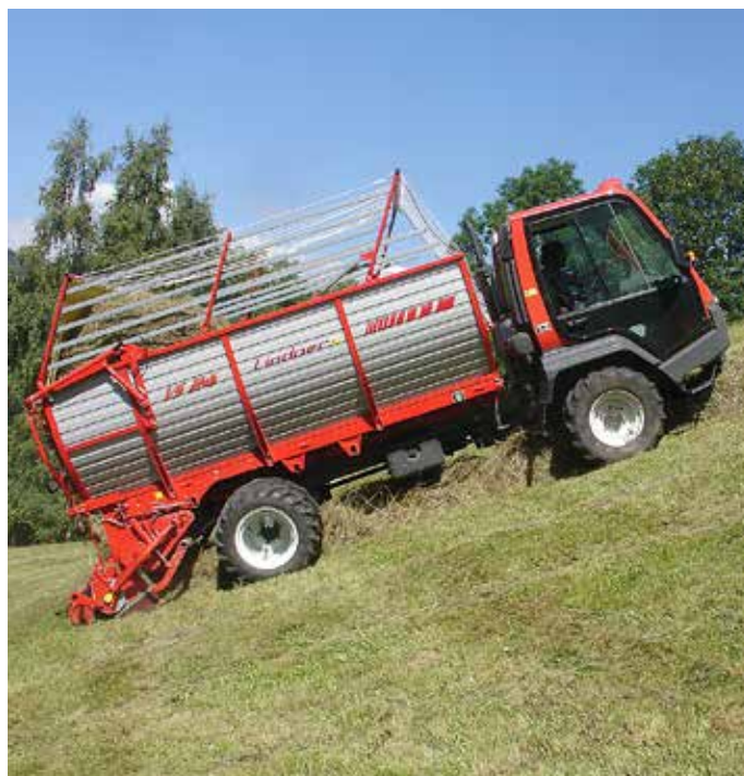
Lindner Unitrac je traktor transporter, ki ima prigrajeno nakladalno prikolico, s katero pobira travo (seno) na zadnjem koncu traktorja. Nakladalna prikolica se lahko odpre, nato pa se na transporter pripne drug priključek. Odlikuje ga zelo nizko težišče, kar mu omogoča delo tudi na večjih strminah. Večina traktorjev transporterjev lahko varno dela na nagibu do 50 %, so pa tudi izvedbe, ki jih uporabljajo do nagiba 60 %.
