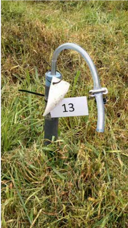
Slika 2: Tenziometrijski lizimeter (levo), sesalna sveča (desno) za merjenje odtoka oziroma vode, ki odteka skozi talni profil.
