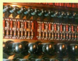
Slika 2.8: Del računalnika z elektronkami.
