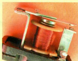
Slika 2.7: V releju električni tok skozi navitje sklence stikala.
