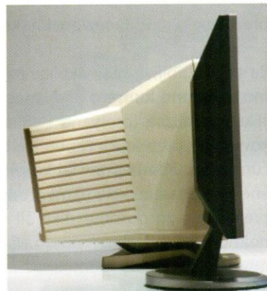
Slika 2.22: Razlika med CRT- in LCD- zasloni smo najbolj opazili v debelini.
