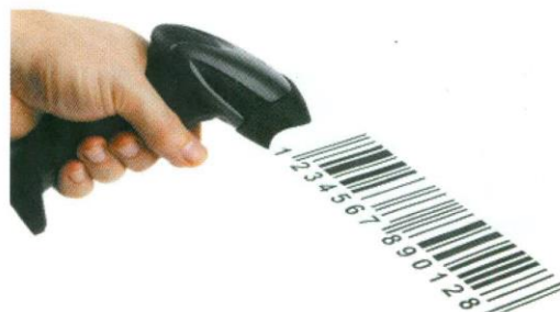
Slika 2.17: Čitalnike črtne kode uporabljamo za hitro zajemanje podatkov o izdelkih.
