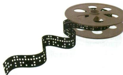
Slika 2.13: Z luknjanimi karticami ali trakom je računalnik lahko prebral znake.
