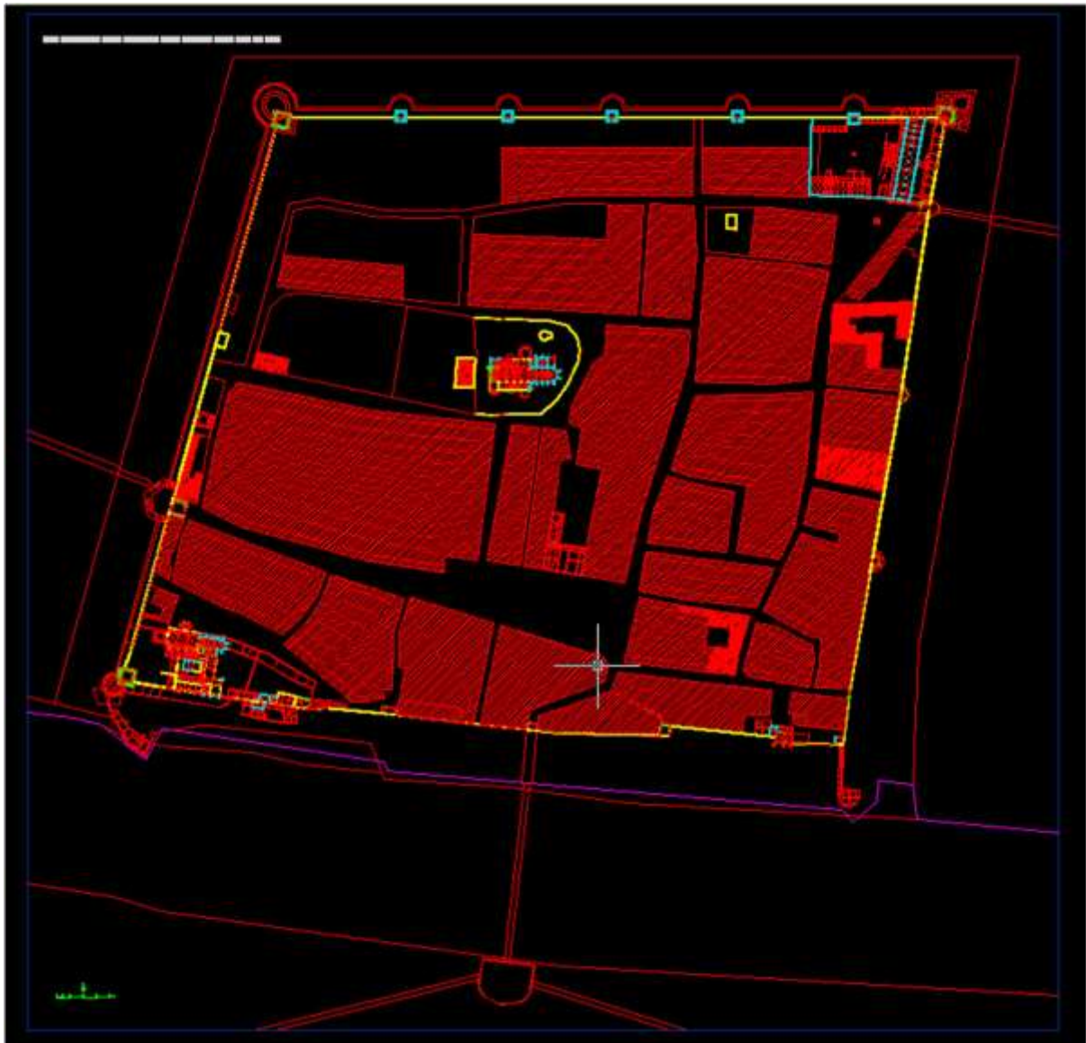
Mariborski obzidni sistem v poznem 15. stoletju. Z rumeno barvo so označeni stari deli iz 13. stoletja, z zeleno barvo dodatki iz zgodnjega 14. stoletja, s svetlo modro barvo pa novi dodatki iz 15. stoletja. Digitalna risba I. Sapač.
