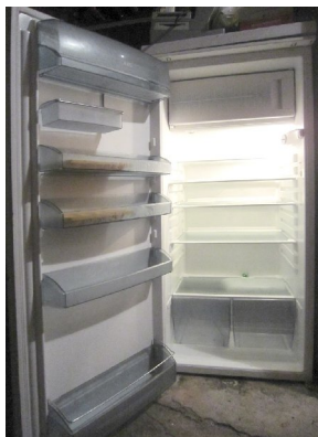
Hladilnik črpa toploto iz hladnejše notranjosti hladilnika v toplejšo kuhinjo.
