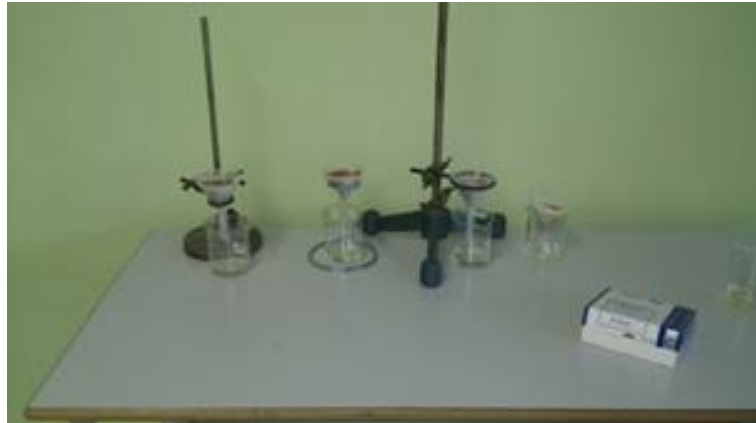
Slika 2: Filtriranje vzorcev prsti (Foto: Aleš Benko)
