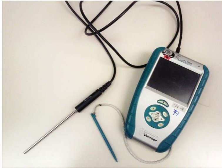
Fotografija 1: Vernierjeva naprava LabQuest za izvajanje meritev, z vmesnikom za merjenje temperature Foto: Tina Stanič
