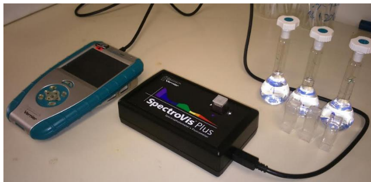
Slika 3: Spektrofotometer Vernje za merjenje vsebnosti fenolov in antioksidantov
