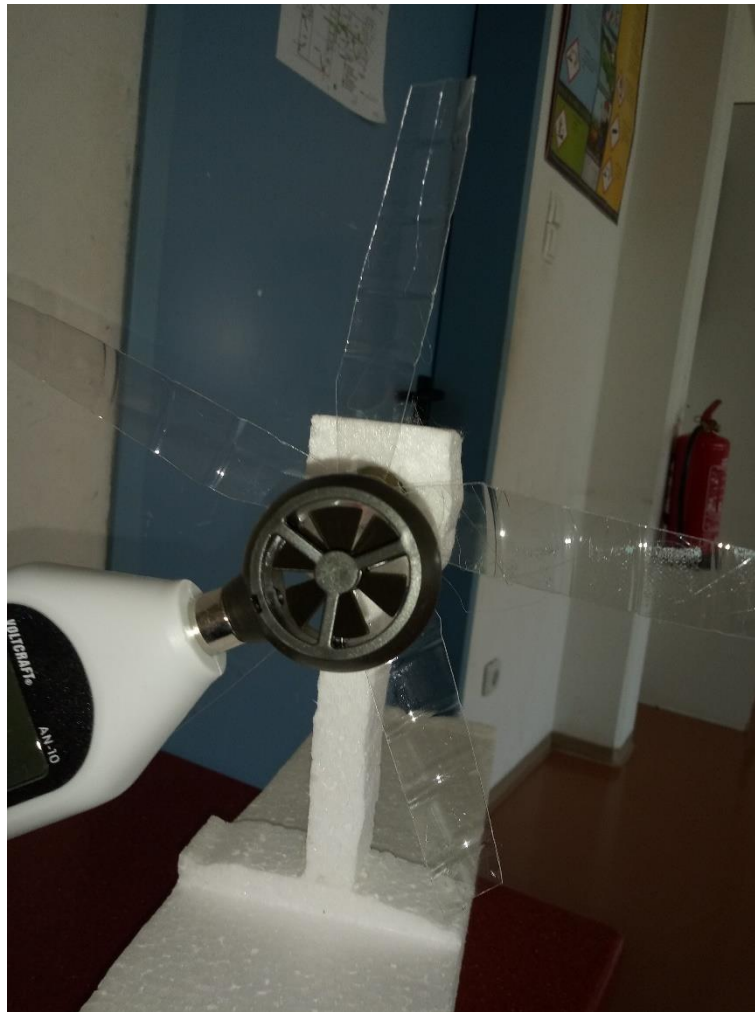
Slika 2: Merjenje hitrosti vetra s pomočjo anemometra
