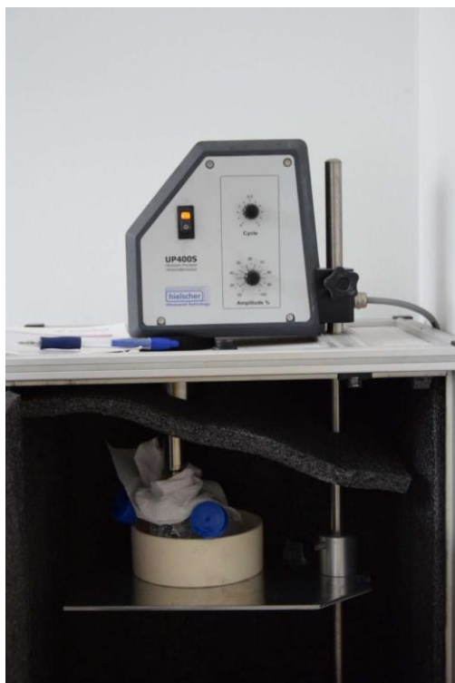
Slika 8: Razbijanje v ultrazvočnem prstu
