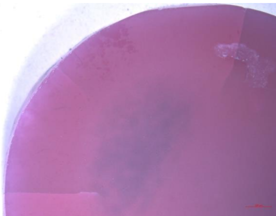
Slika 36: Obkrušen rob na vzorcu
