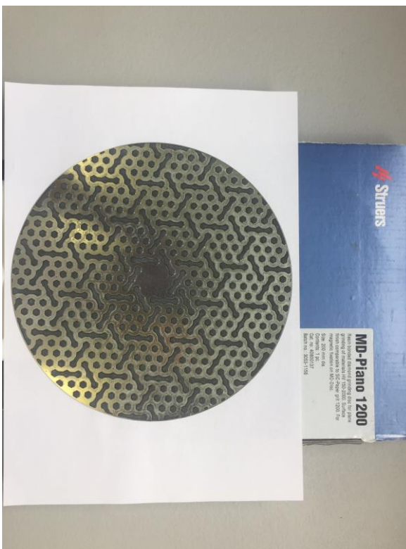
Slika 19: Manj groba brusilna plošča
