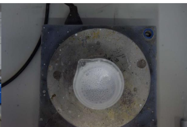
Slika 4: Zmes ob dodanem \text{Al}_2\text{O}_3
