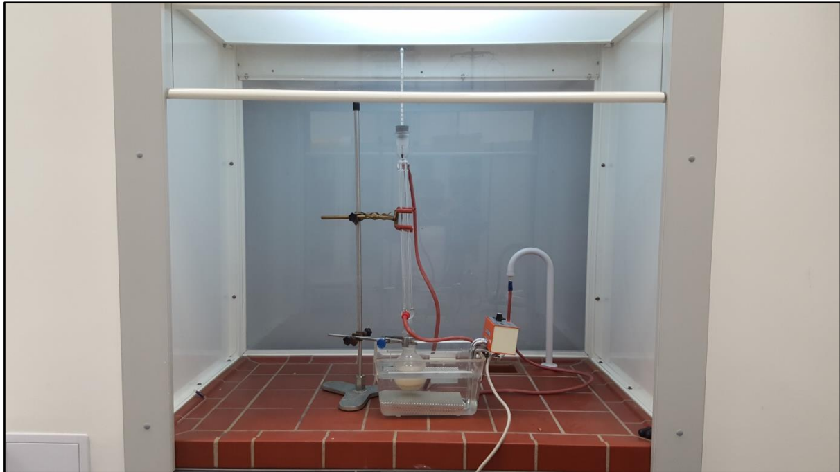
Slika 9: Aparat za refluks v digestoriju Gimnazije Kranj
