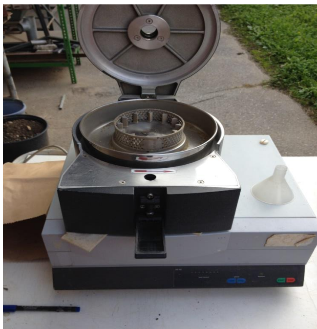
Figura 6: Mlin za mletje suhih vzorcev korenin in nadzemnih delov rastlin (RETSC ZM100) uporabljen v pripravi vzorcev na Biotehniški fakulteti Univerze v Ljubljani. (Hrobat, 2014)
