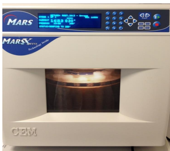
Figura 7: Mars mikrovalovna pečica uporabljena v pripravi vzorcev na Biotehniški fakulteti Univerze v Ljubljani. (Hrobat, 2014)
