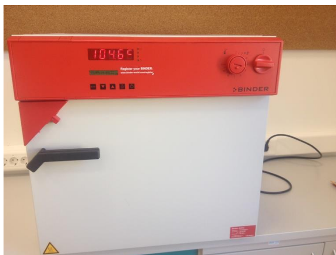
Figura 16: Fotografija uporabljene BINDER vacuum sušilne peči za sušenje vzorcev. (Hrobat, 2014)
