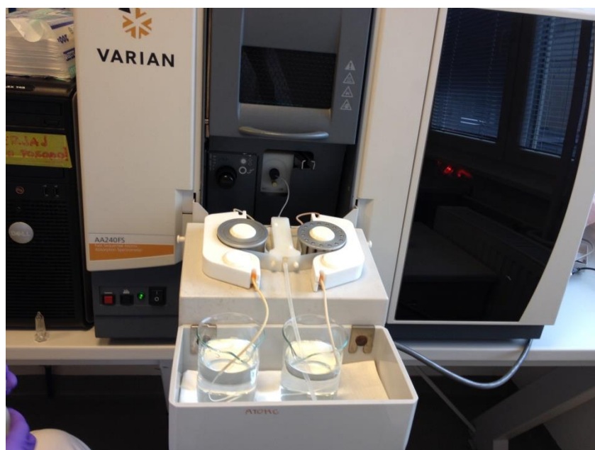
Figura 8: Atomski absorpcijski spectrophotometer (AAS Varian) uporabljen v pripravi vzorcev na Biotehniški fakulteti Univerze v Ljubljani. (Hrobat, 2014)
