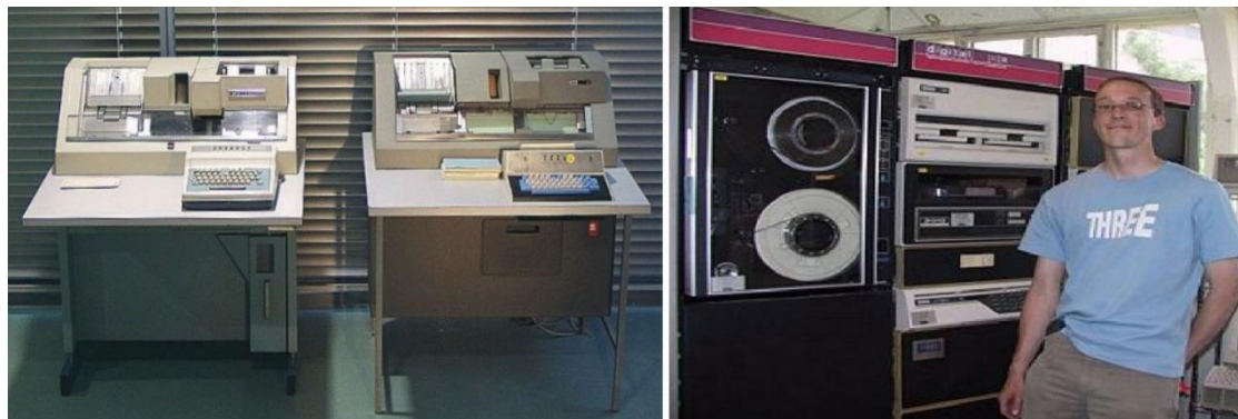
Slika 6. Dve tipkalni enoti za luknjanje kartic – lunjači (levo) in računalnik DEC Digital PDP 11/34 (desno). Vir: Roškar;
