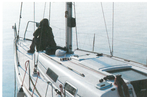
▲ Slika 29 Čolne izdelujejo iz poliestra, ki ga ulijejo v kalup in v njem zamrežijo z dodanimi steklenimi vlakni.
