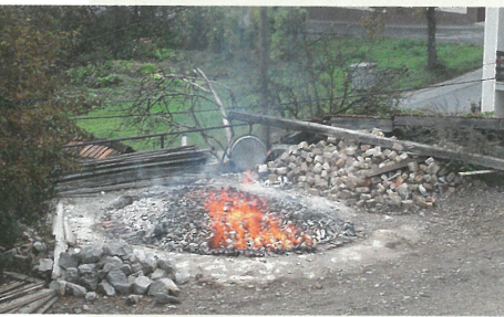
▲ Slika 7 Pridobivanje žganega apna v apnenici.
