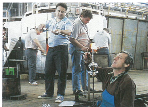
▲ Slika 53 Steklo pridobivajo iz mešanice kremenovega peska, apnenca in natrijevega karbonata, ki jo stalijo pri okoli 1500 °C.
