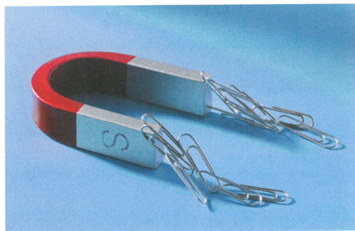
▲ Slika 38 Zaradi magnetnih lastnosti železa iz njega izdelujejo trajne magnete, elektromagnete in jedra transformatorjev.
