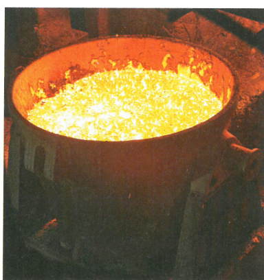
▲ Slika 13 V livarnah pri visokih temperaturah prelivajo raztaljeno kovino v kalupe in tako oblikujejo različne izdelke.
