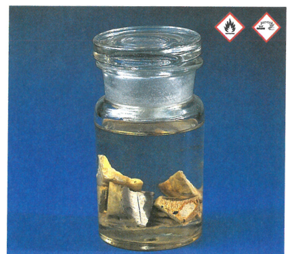
▲ Slika 23 Natrij zaradi reaktivnosti s kisikom in z vodo hranimo v petroleju. Znaka za nevarnost nas opozarjata, da je natrij vnetljiva in jedka snov.
