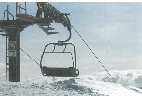
▲ Slika 40 Pri žičnicah in vlečnicah uporabljajo jeklene vrvi.
