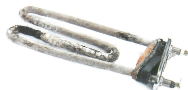
▲ Slika 26 Električna grelna cev v pralnem stroju, ki je obložena z vodnim kamnom.
