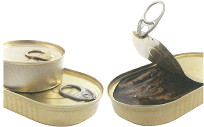
▲ Slika 43 Jeklene pločevinke za hrano so prevlečene s tanko plastjo kositra.
