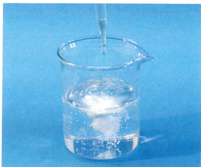
▲ Slika 16 Pri reakciji med raztopinama natrijevega klorida in srebrovega nitrata nastane bel srebrov klorid.
