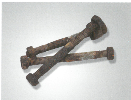
▲ Slika 3 a) Pri rjavenju jeklenih žbljev in vijakov je nastala rja.
