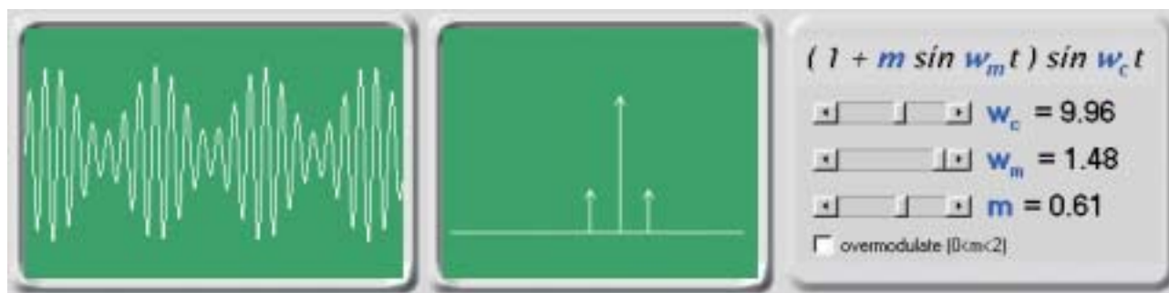
Slika 1: Simulacija amplitudne modulacije. [2]
