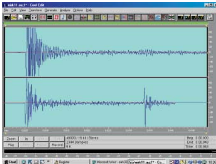
Slika 2. Na sliki prikazana signala sem izmeril zaporedoma. Skupaj sta postavljena zato, da je razviden signal, ki je pripotoval po cevi (spodnji signal). V zgornjem primeru je bila cev pokrita.
