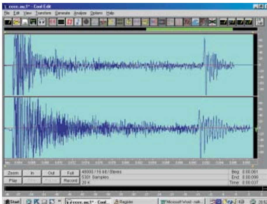
Slika 3. Posnetek potovanja zvoka po cevi. Zgornji posnetek je narejen pri sobni temperaturi, pri spodnjem je temperatura zraka višja. Čas potovanja zvoka je krajši, hitrost pa večja.
