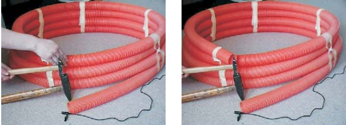
Slika 1. Pred enim ustjem cevi je roka, ki preprečuje, da bi zvok ob udarcu kladiv potoval tudi po cevi do mikrofona. Na desnem posnetku ni več roke, tako da potuje zvok do mikrofona neposredno (smer puščice) ter z zakasnitvijo tudi po cevi. Med trkom sta obe kladivi v zraku približno 1 dm od ustja gornjega dela cevi.
