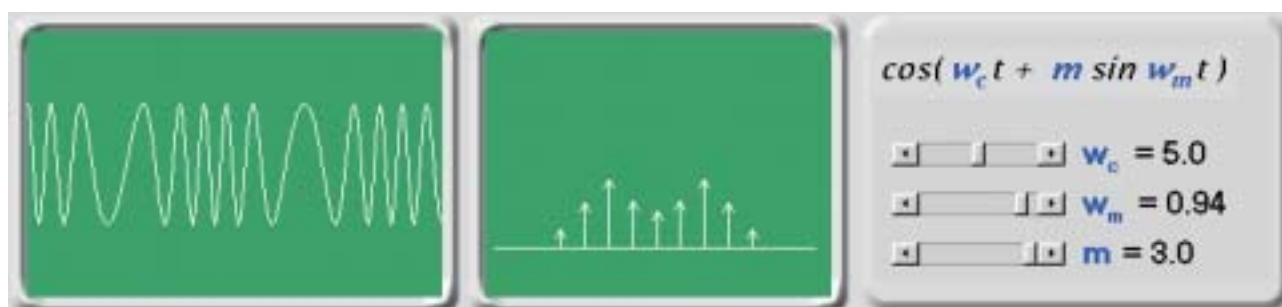
Slika 2: Simulacija frekvenčne modulacije. [3]
