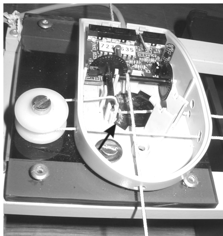
Slika 5. Detajl priprave. Poleg izvrtin sta vidni še vodili vrvice. Z njima izboljšamo oprijem vrvic na vreteni miške. Izdelamo jih iz nerjaveče jeklene žice.
